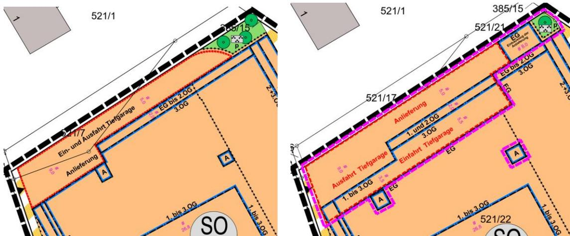
Abb. 6: Anpassung der Zufahrten einschl. Baugrenzen im Erdgeschoss – Vergleich vorher / nachher
