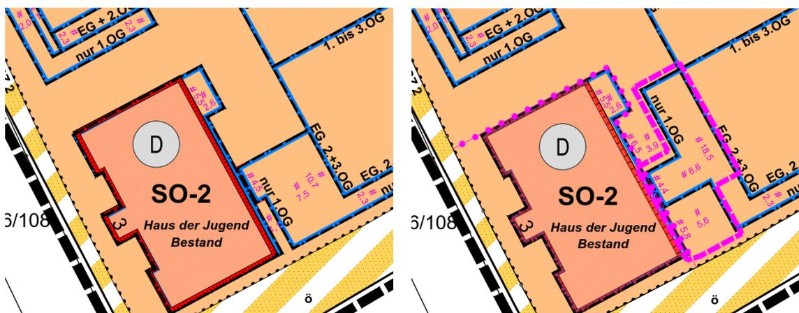
Abb. 7: Anpassung der Baugrenzen im ersten Obergeschoss – Vergleich vorher / nachher
