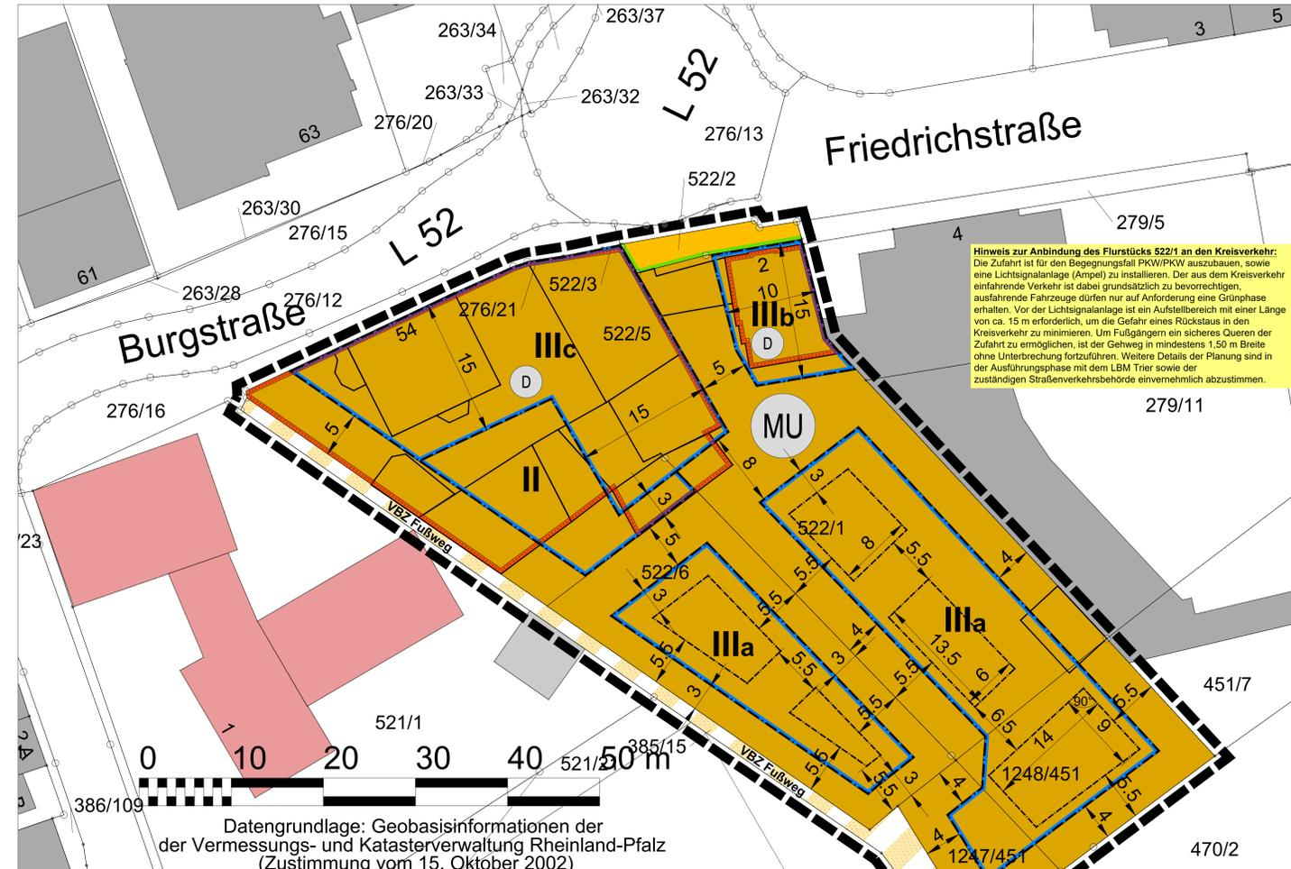
Hinweis zur Anbindung des Flurstücks 522/1 an den Kreisverkehr: Die Zufahrt ist für den Begegnungsfall PKW/PKW auszubauen, wobei eine Lichtsignalanlage (Ampel) zu installieren...
