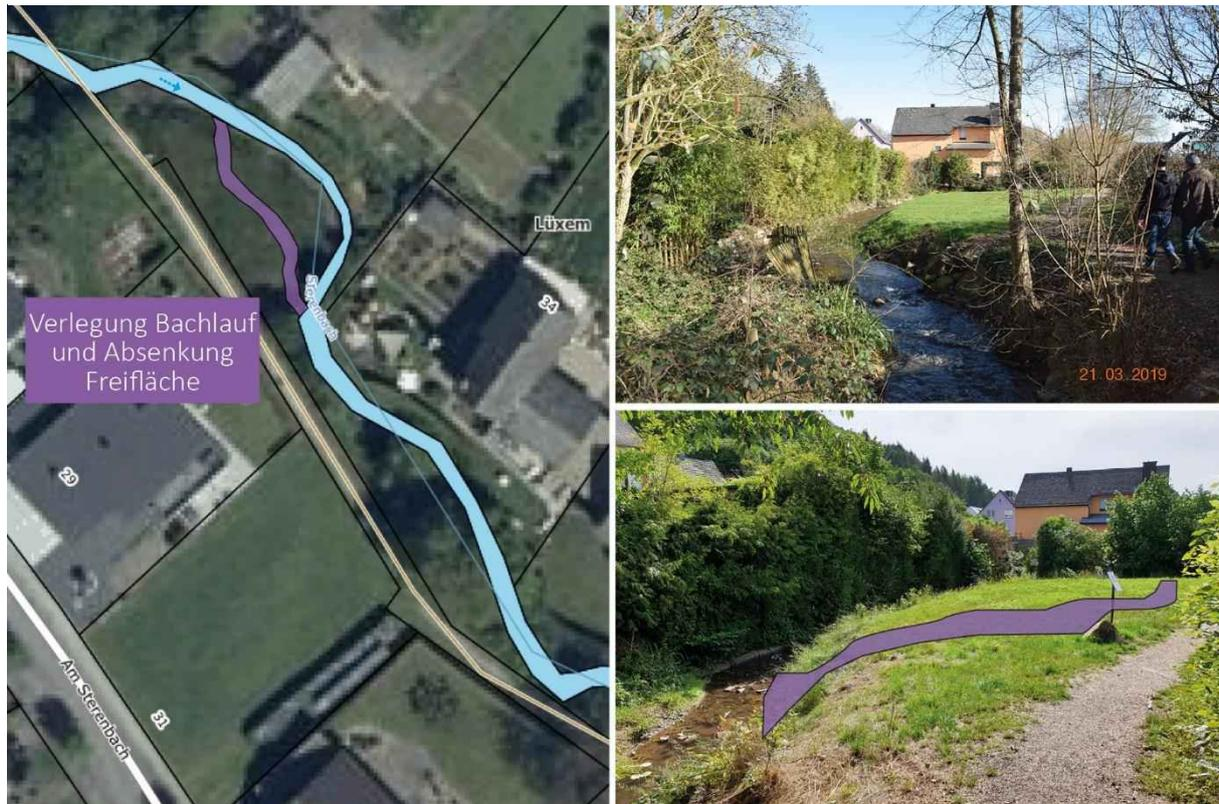
Dem Nachbar (34 A) stand Hochwasser nur bis knapp unter die Hecke, Haus und Keller sind ungefährdet. Dem Gewässer kann auch hier zwischen Gartengrundstücken und Fußweg mehr Platz gegeben, die linksseitigen Uferbefestigungen entfernt und leichte Böschungen modelliert werden.
