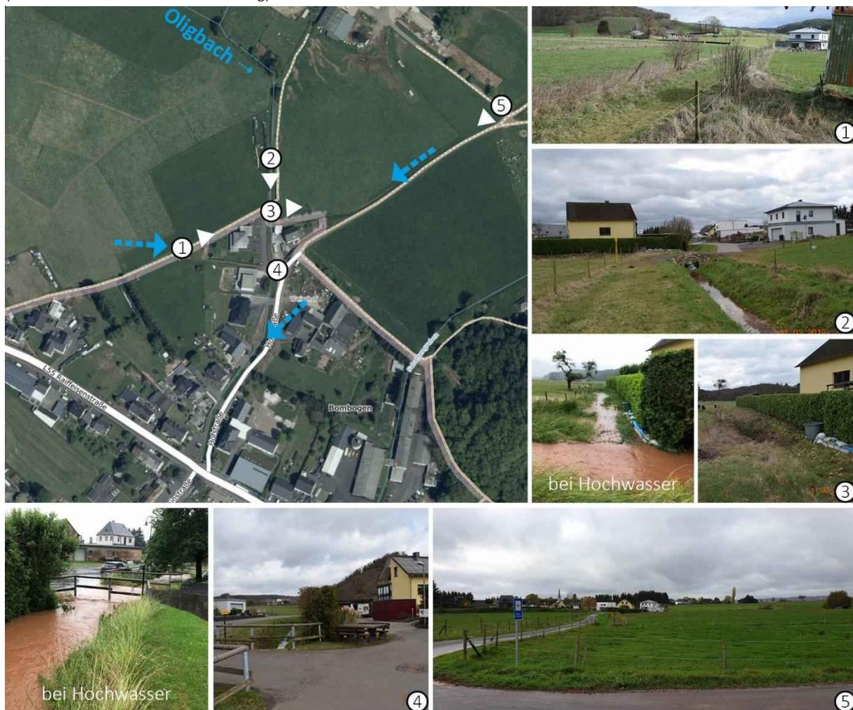
Im Bereich der Durchlässe sind Ablagerungen erkennbar, welche zeitnah geräumt werden sollen, um den Abflussquerschnitt zu erhalten. Eine regelmäßige Kontrolle und Unterhaltung der Durchlässe ist notwendig, um den Durchfluss sicherzustellen und den Abflussquerschnitt zu erhalten. Sollten zukünftig die Durchlässe nochmals erneuert werden, soll geprüft werden, ob diese vergrößert bzw. durch Haubenkanäle mit Kastenprofil ersetzt werden können.
